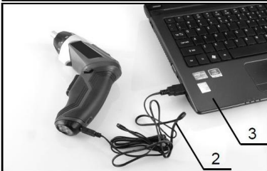
1. USB priză de conectare pentru încărcare 2. Cablu de încărcare USB 3. Dispozitive USB externe
